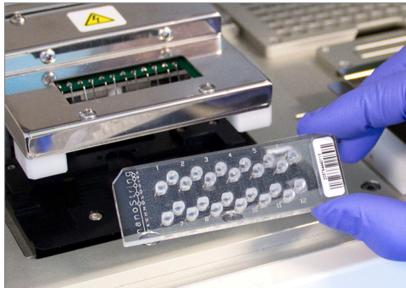
ABBILDUNG 5.18: Setzen Sie eine ungebrauchte Cartridge in der dargestellten Ausrichtung in die Prep Station ein.
