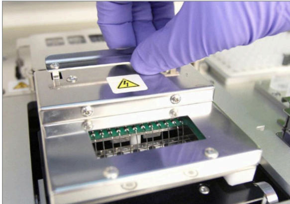
FIGURE 5.29 : Dégagement du bloc électrodes à la fin du traitement d'une série
