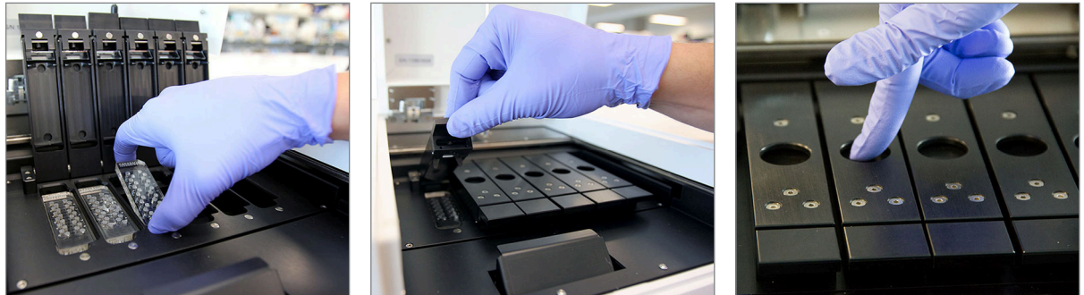
FIGURE 6.4 : Orienter les cartouches avec le code-barres vers l'utilisateur lors de leur insertion dans le Digital Analyzer. Fermer délicatement les loquets magnétiques et bien appuyer sur la plaque métallique au-dessus de la cartouche après la fermeture du couvercle pour s'assurer que la cartouche repose à plat.
