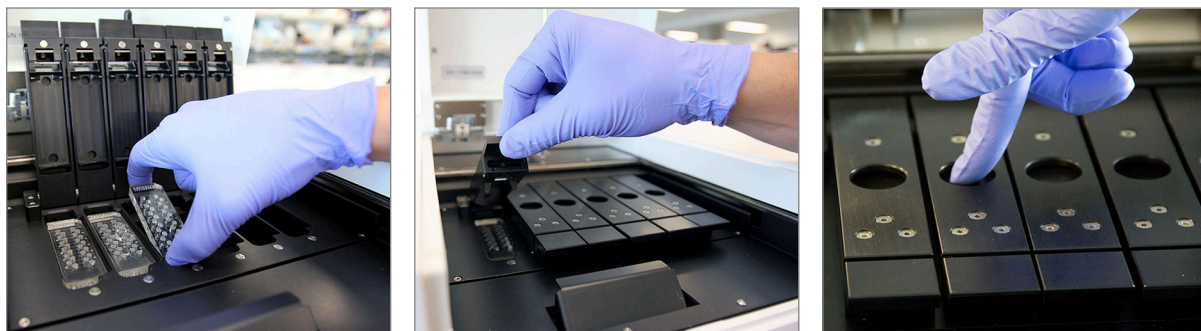
FIGURA 6.4: quando si mettono le cartucce nell'analizzatore digitale, orientarle con il codice a barre rivolto verso l'utente. Chiudere con cura le clip magnetiche e assicurarsi di comprimerle sulla piastra di metallo sopra la cartuccia dopo che lo sportello è stato chiuso per assicurarsi che la cartuccia sia in posizione piana.
