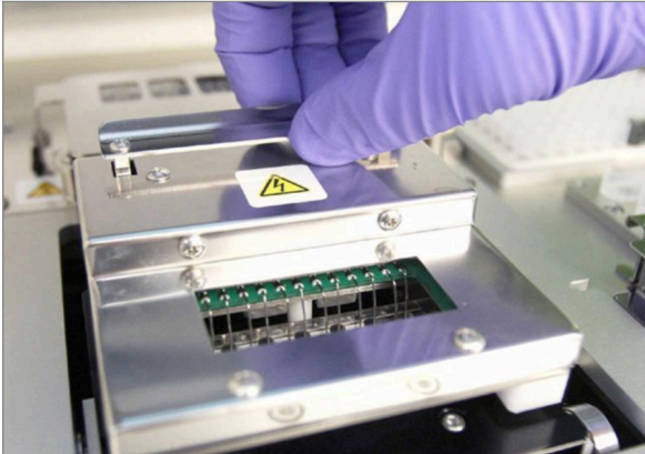
FIGURA 5.29: rilascio della struttura degli elettrodi dopo il completamento di un ciclo
