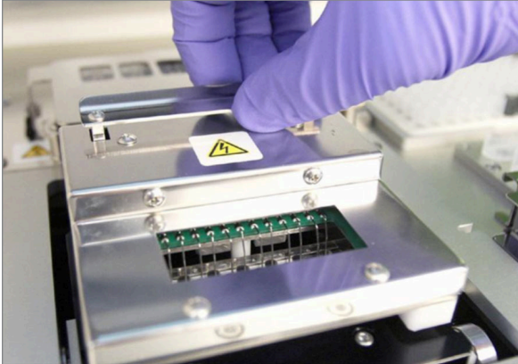
AFBEELDING 5.29: De behuizing loskoppelen na voltooiing van de uitvoering
