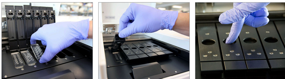
FIGUR 6.4: Snu kassetten med strekkoden mot brukeren når de plasseres i Digital Analyzer. Lukk de magnetiske klemmene forsiktig og sørg for å presse ned på metallplaten over kassetten etter at dekslet er lukket for å sikre at kassetten ligger flatt.
