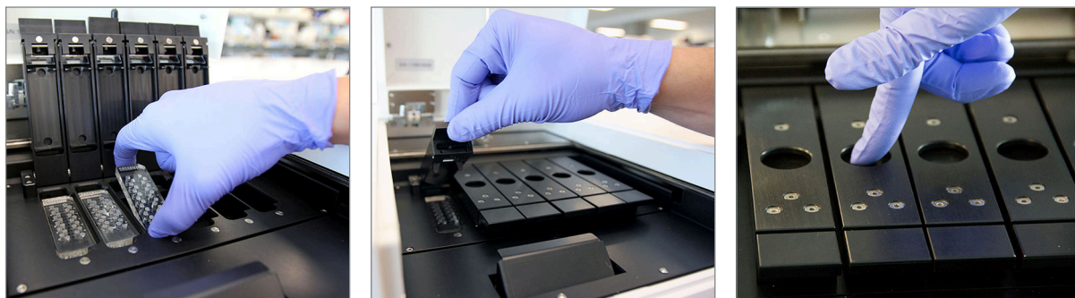
KUVA 6.4: Suuntaa kasetit niin, että viivakoodi tulee käyttäjää kohti, kun asetat niitä digitaaliansaattoriin. Sulje magneettipidikkeet varovasti ja muista työntää kotelon yläpuolista metallilevyä alaspäin kannen sulkemisen jälkeen, jotta kasetti jää varmasti vaakasuuntaan.
