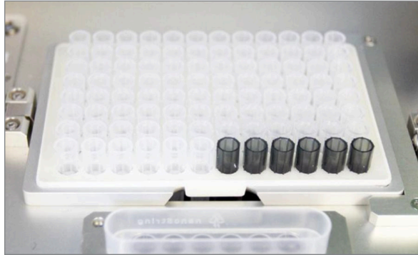
KUVA 5.14: Pipetinkärjet ja folion lävistimet sisältävän telineen oikea sijoittelu.
