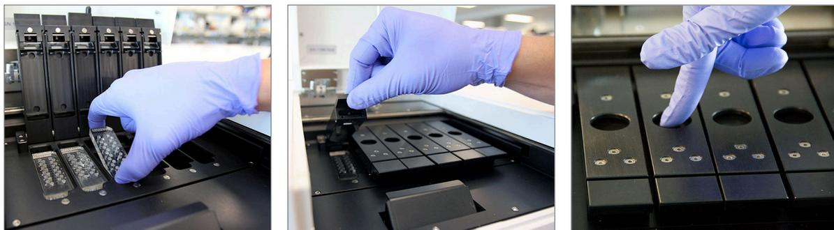
**FIGURA 6.4:** Oriente os Cartuchos com o código de barras virado para o utilizador, aquando da sua colocação no Digital Analyzer. Feche as pinças magnéticas com cuidado e, depois de fechar a tampa, pressione a placa metálica acima do Cartucho para assegurar o assentamento do mesmo.
