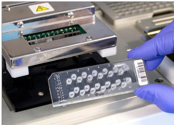
**FIGURA 5.18:** Inserir um Cartucho não utilizado na Prep Station, na orientação mostrada
