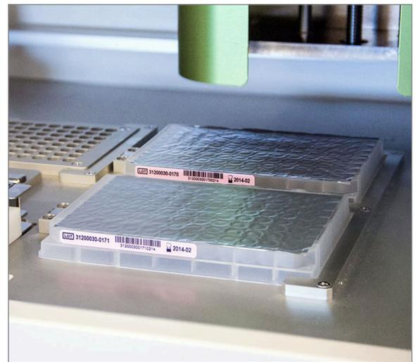
FIGURA 5.11: Utilização dos pinos de posicionamento para a colocação correta das Placas de Reagentes.
