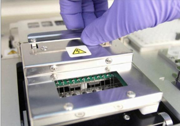
**FIGURA 5.29:** Libertação da unidade de elétrodos após a conclusão de um ciclo
